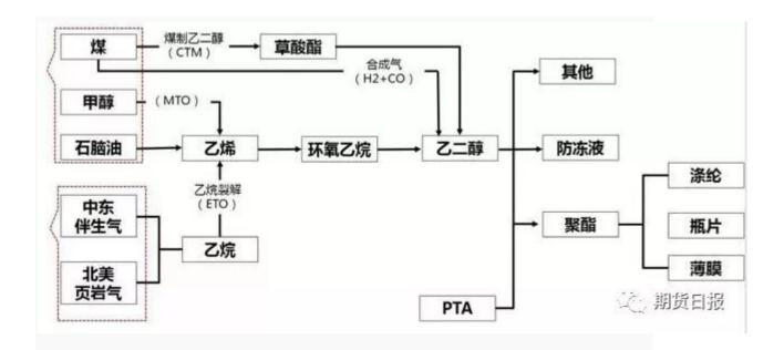
非石油路线法是以天然气、煤炭或生物质资源为原料,采用不同的方法合成乙二醇。其中,以天然气和煤炭为原料制取乙二醇采用的是"天然气/煤炭→合成气(CO+H2)→环氧乙烷→乙二醇"路线。我国目前已大规模工业化的是褐煤制乙二醇,该种生产工艺符合我国缺油、少气、煤炭资源丰富的资源特点,且相对石油路线法成本优势明显,具备工艺流程短、能耗低、水耗低、排放低、盈利能力好等优势。
