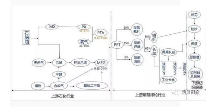
涤纶的直纺和切片纺生产流程。按照是否经过 PET 切片,涤纶的生产流程可以分为直纺和切片纺两种。直纺(又称一步纺),是指精对苯二甲酸 PTA 和乙二醇 EG 在生产过程中不生成切片,而是直接喷丝而成,即"PTA+EG→涤纶",目前大多聚酯生产厂家都采用直纺。切片
